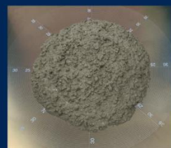
FMSによる正確なスランプフロー測定。そのまま撮影しデータとしての活用が可能
