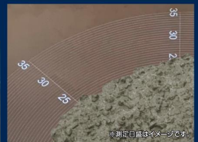
FMSによる正確なスランプフロー測定。そのまま撮影しデータとしての活用が可能
